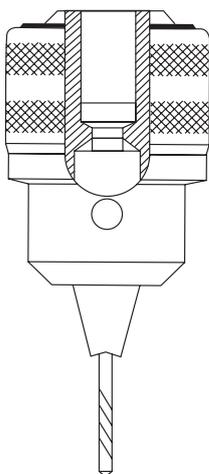
Modèle L4200V00132 avec adaptateur 6 pans 1/4» pour utilisation sur visseuse
